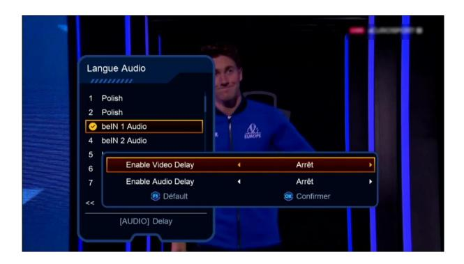
Le délai maximal pour la fonction Video delay est de 4 secondes
